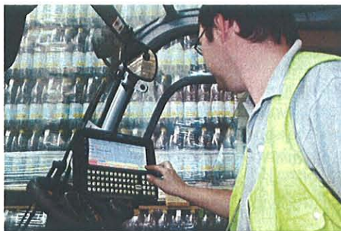
Die Stapler wurden mit mobilen Fahrzeugterminals mit Touch Screen ausgestattet.
